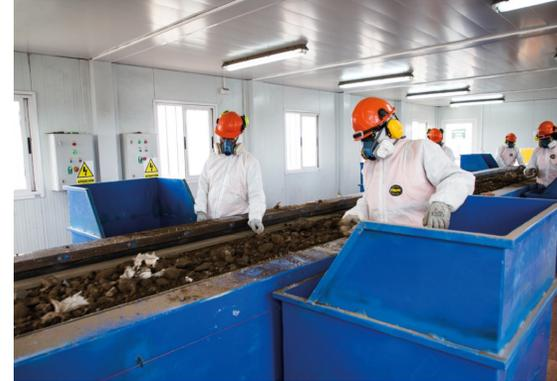
Teniendo como base la experiencia pionera de POSADA ORGANIZACIÓN en España, ofrecemos este servicio de aprovechamiento de materiales mediante técnicas de molienda y chancado, valorizando para el cliente el residuo, al ser empleado en relleno de zanjas, formación de bases, drenajes y otros.
